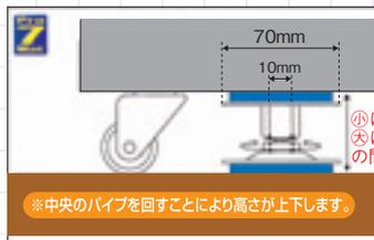
超粘着振動吸収素材(ウレタンエラストマー※)を使用して地震時の揺れを吸収しピアノの転倒・暴走を防止する全く新しい器具です。床面とピアノの間に支える様に据え付けることで揺れを吸収します。装着後2時間経てば震度7クラスの地震でもピアノは倒れません。しかも移動時はゆっくりとボルトを逆に回すと器具が外れる不思議な青い耐震マットです。(プロセブン社にて震度7耐震実験済み)
